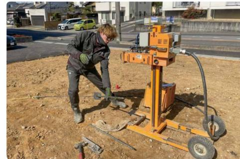
スウェーデン式サウンディング試験を中心に地盤調査をしています。
