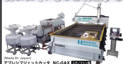
各種金属材料、磁性体、複合材、CFRP、樹脂、ガラス、セラミックス、石材、チタン、インコナル など
